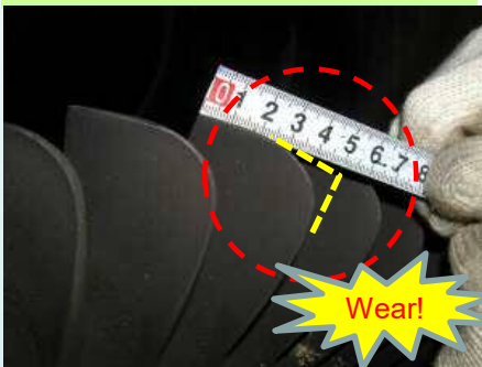
タービン翼 (黄色破線は元々の翼の形状)
