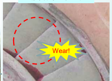
ノズル (翼端部が細る)
